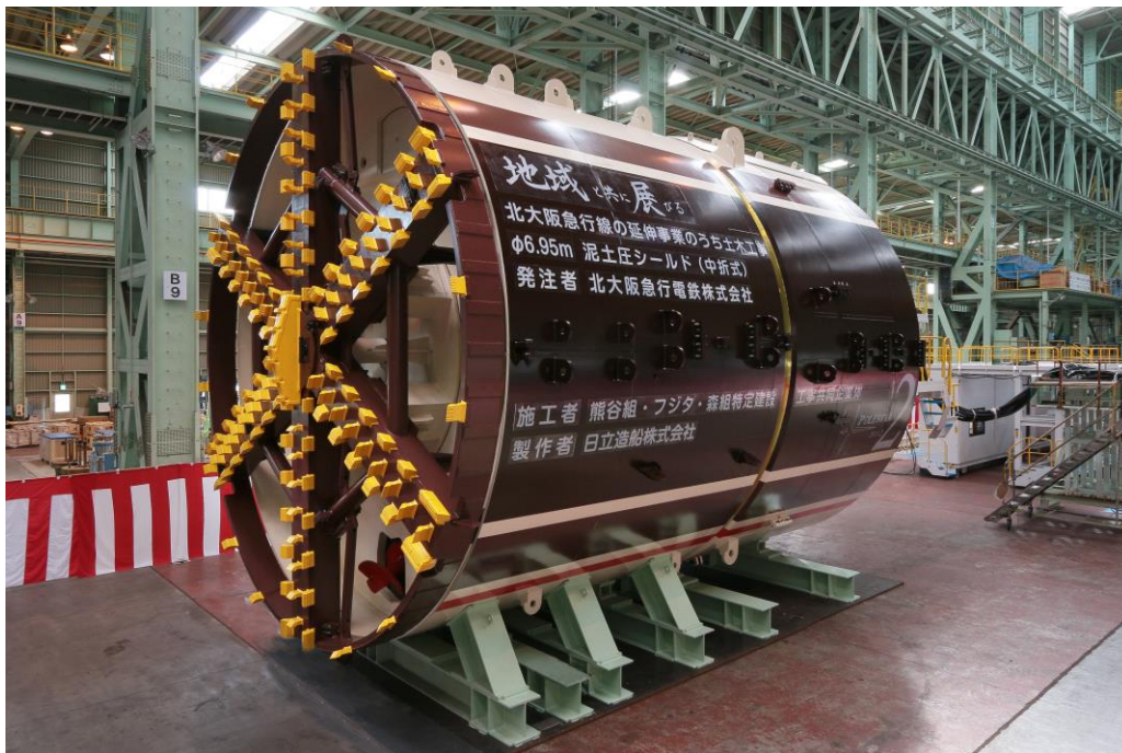
2号機北行きシールド機
