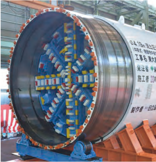
既設管切削時
